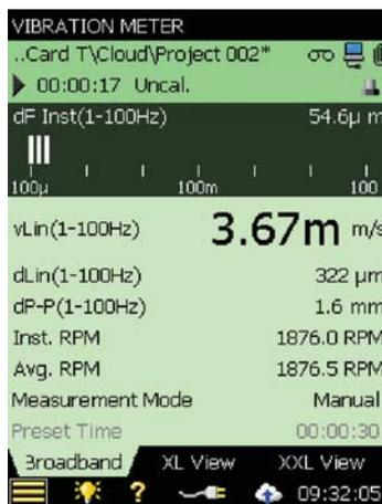
La vibración se mide a menudo en unidades de velocidad (en/s o mm/s) o desplazamiento (Mil y mm). Esto es especialmente habitual en el mantenimiento, la reparación o la revisión (MRO) de valiosas máquinas, como compresores y turbinas de gas.
