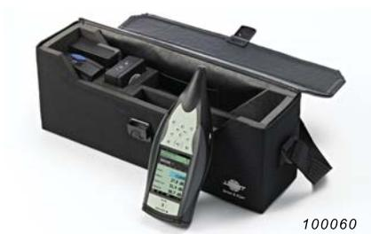
Una vez tomadas las mediciones, deberá hacer algo con ellas. El analizador portátil le ofrece tres opciones de almacenamiento: disco interno, tarjetas de memoria Secure Device (SD) o memoria USB. Desde allí, los cables USB o LAN incluidos le facilitarán la transmisión de los datos a su PC o a su ubicación de red. En el caso de haber utilizado una tarjeta de memoria, solo tendrá que introducirla en el lector de tarjetas de su equipo.
