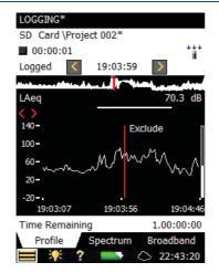
Lorsque ce module optionnel est actif, le Type 2250-L devient un appareil polyvalent permettant d'obtenir des historiques chronologiques. Le Module enregistrement vous permet de choisir des paramètres large bande et de les enregistrer à des intervalles de 1 s à 24 h. Dans le même temps, les paramètres  $L_{AF}$ ,  $L_{AS}$  et  $L_{Aeq}$  peuvent être enregistrés à intervalles de 100 ms.
