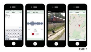
Une fois la connexion avec le analyseur établie, vous pouvez commencer, arrêter et interrompre vos mesures tout en conservant une distance de sécurité. Pendant la mesure du bruit, le profil LAF instantané apparaît sur le Field App.
