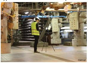
Le Type 2250-L est un outil puissant, facile d'utilisation, vous permettant de travailler de manière plus productive et plus fiable sur la mesure du bruit. Il a été développé en prenant tout particulièrement en compte les bruits au poste de travail.
