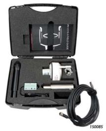
Les stations météorologiques utilisent une technologie d'ultrasons et fonctionnent bien au-delà de la limite de fréquence supérieure du microphone. Reliez votre station météorologique à votre sonomètre, puis mettez-la sous tension. Vous pouvez dès à présent commencer les mesures sans devoir installer de logiciel. La station météorologique étant alimentée par la batterie du sonomètre, aucune batterie supplémentaire n'est requise.
